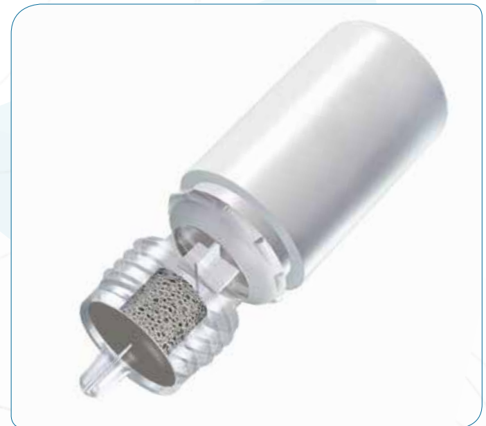
Figura 4. El contenido del interior del vial permanece estéril gracias a la incorporación de un filtro esterilizante que sustituye a la necesidad de uso de los conservantes
